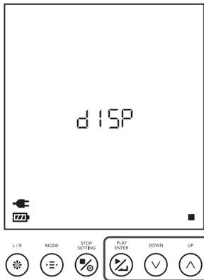
2. 中央表示部に画面消灯までの秒数表示されたら、アップ/ダウンボタン  $\wedge$  /  $\vee$  を押し、お好みの時間を選択し、再生/決定ボタン  $\blacktriangleright$  /  $\blacktriangleleft$  を押します。(5秒から300秒の範囲で設定できます)
