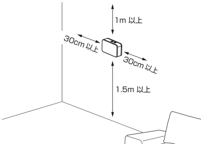
1. 事前にビスを取り付ける壁面の強度が十分であることを確認してください。
