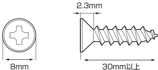
3. 壁面取り付け用ビスを210mm間隔で水平に壁面に取り付けます。このとき、ビスの部分が5mm露出するようにしてください。
