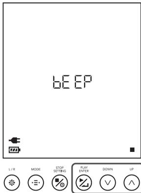
2. 中央表示部に **On** または **Off** が表示されたら、アップ/ダウンボタン  $\wedge$  /  $\vee$  を押し、操作音のオン / オフを選択し、再生/決定ボタン  $\blacktriangleright$  /  $\blacktriangleleft$  を押します。
