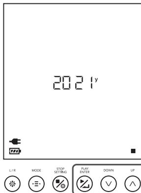
3. 中央表示部に月日が点滅したら、アップ/ダウンボタン  $\wedge$  /  $\vee$  を押して数字を選び、再生/決定ボタン  $\blacktriangleright$  /  $\blacktriangleleft$  を押し、月日を設定します。
