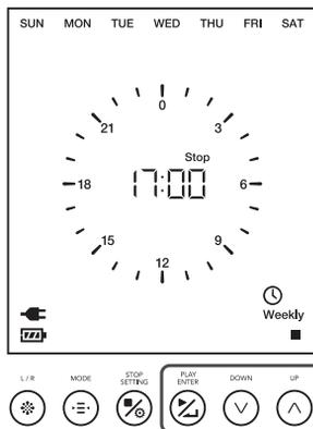
5. 中央表示部に「Lch」が表示されたら、噴霧チャンネル切替ボタン
