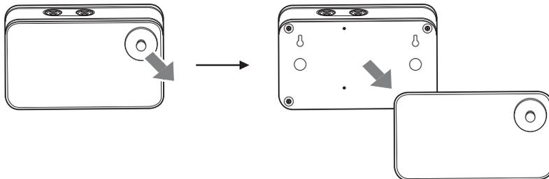
5. 本体の壁掛け用ホール2ヶ所をビスにかけたあと下方向に動かして固定します。本体が壁面に固定され、落ちないことを確認します。
