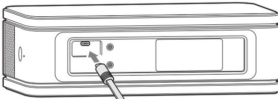
**!** 本体の転倒やUSBケーブル破損の原因になりますので、本体底部にUSBケーブルを接続した場合は、本体を床に置いたり、クレードルにセットして使用することはできません。
