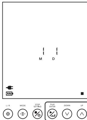
4. 中央表示部に時分が点滅したら、アップ/ダウンボタン  $\wedge$  /  $\vee$  を押して数字を選び、再生/決定ボタン  $\blacktriangleright$  /  $\blacktriangleleft$  を押し、時分を設定します。
