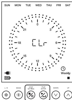
4. 噴霧パターンの消去が完了すると噴霧パターンの全てのドットが消灯し、曜日表示部が点滅します。
