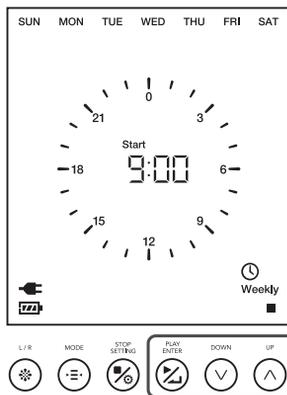
4. 中央表示部に **Stop** が表示されたら、アップ/ダウンボタン  $\wedge$  /  $\vee$  を押して、スケジュール運転の終了時刻を選択し、再生/決定ボタン  $\blacktriangleright$  /  $\blacktriangleleft$  を押します。
