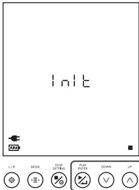
2. 中央表示部の  $\text{Init}$  が点滅し、初期化の確認を行います。消去する場合は、再生/決定ボタン  $\blacktriangleright$  /  $\blacktriangleleft$  を押します。
