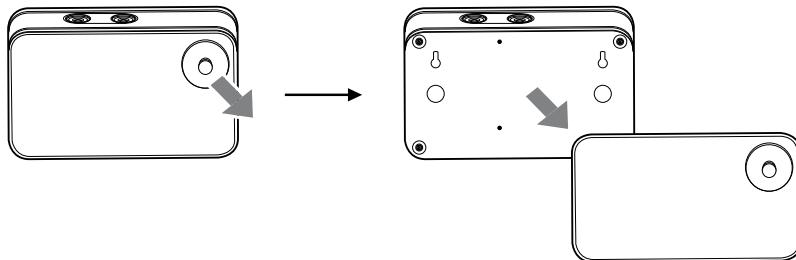
5. 本体の壁掛け用ホール2ヶ所をビスに掛けたあと下方向に動かして固定します。本体が壁面に固定され、落ちないことを確認します。
