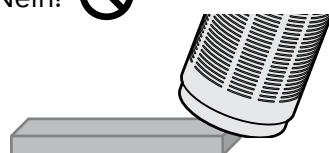
Verwenden Sie das Produkt nicht an geneigten, instabilen oder erhöhten Orten. An solchen Orten könnte das Produkt herunterfallen, umkippen oder fehlerhaft arbeiten.
